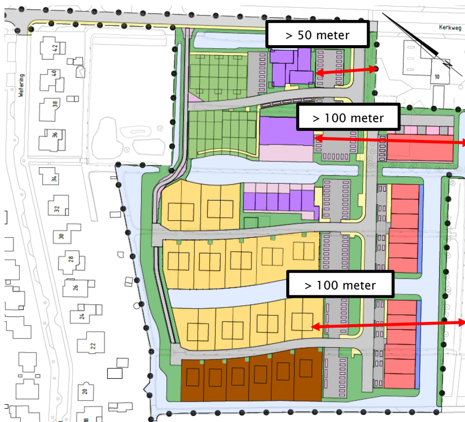
Afbeelding 22: Nieuwe woningen t.o.v. bedrijven op bedrijventerrein
