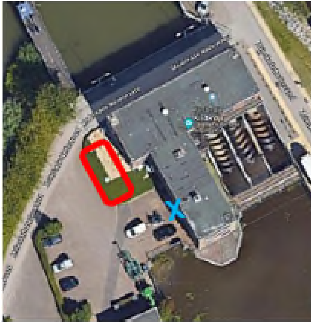
Figuur 6.1: Locatie met verontreinigingen (zinkverontreiniging in grond: blauwe kruis, minerale olie verontreiniging in grond- en grondwater: rode contour)
