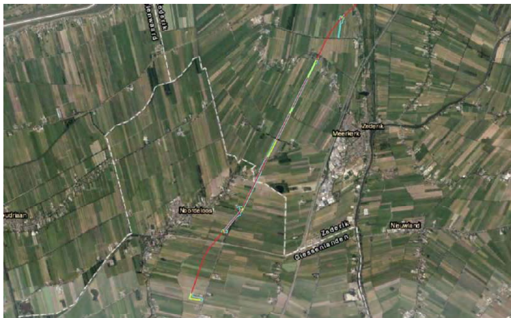
Figuur 4.14. Het zuidelijke deel van het HTL tracé. De HDD-borings zijn in rood weergegeven, geel betreffen open ontgravingen. De werkstroken zijn blauw weergegeven (bron achtergrond: Esri).
