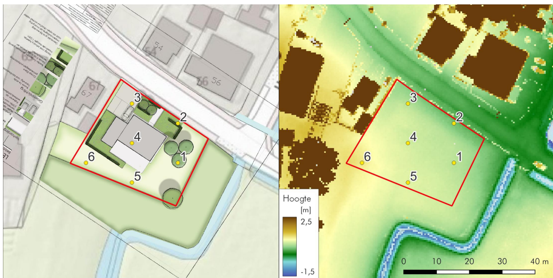
Figuur 10: Lioessens, Doarpstrijte naast 67: boorpuntenkaart met als achtergrond een plankaart zoals aangeleverd door de opdrachtgever (links) en een hoogtekarte gemaakt met het AHN4 (rechts). De genummerde punten zijn de locaties van de boringen.
