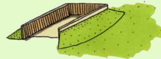
Sleufsilo inpassen met lage grondwal
