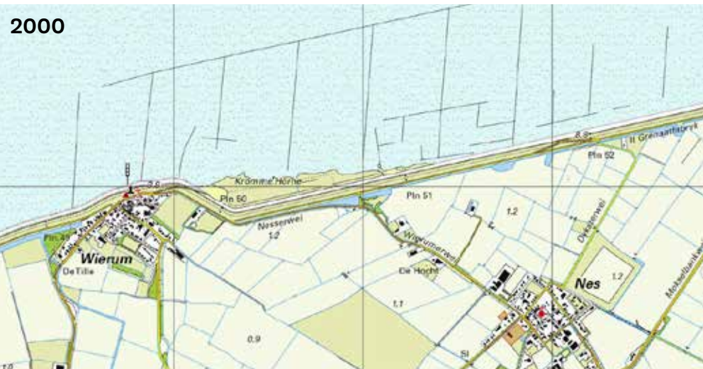
Afb.5.28 Waar de landaanwinningswerken zijn stilgelegd en niet meer worden onderhouden vindt er afslag van de kwelder plaats. Bijvoorbeeld ten oosten van Wierum bij de Kromme Horne. Het verschil is goed te zien bij het vergelijken van de topografische kaarten van 1950 en 2000.
