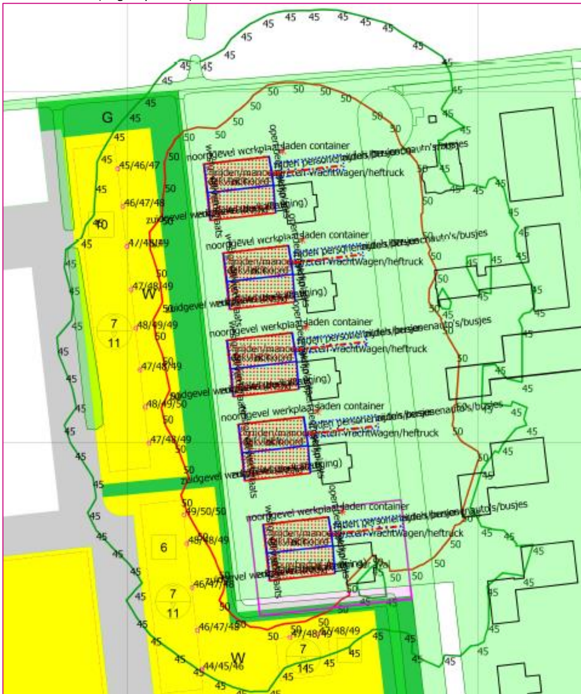
Figuur 3.2: berekende 45/50 dB(A) etmaalwaarde geluidcontouren o.b.v. geluidgegevens Bouwbedrijf A. van der Wal (5x gedupliceerd)
