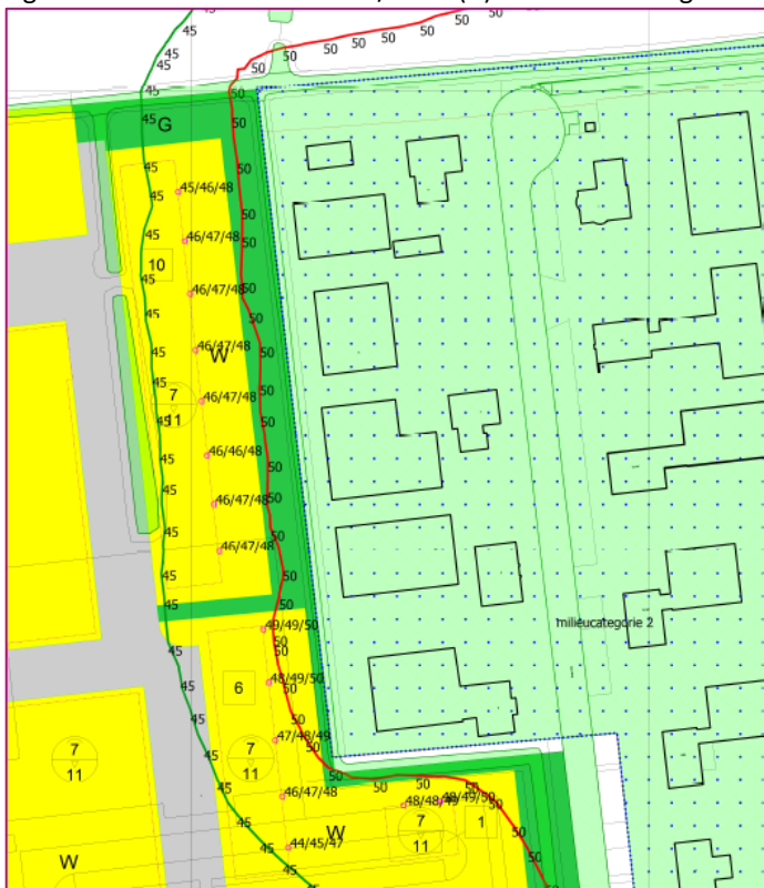
Figuur 3.1: berekende 45/50 dB(A) etmaalwaarde geluidcontouren o.b.v. kentallen
