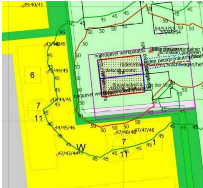
Figuur: geluidsbelasting/contouren ten gevolge van De Veiling 3
