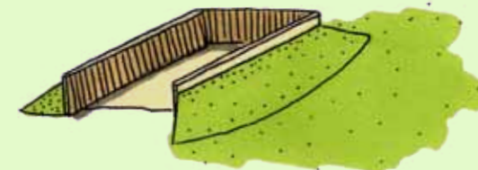
Sleufsilo inpassen met lage grondwal
