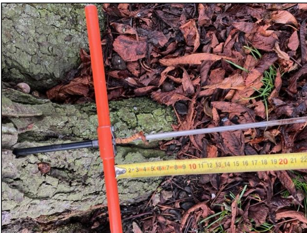
Foto 5, boomnummer 3, boorspaan na 4 cm aangetast hout, daarna alleen nog rot hout
