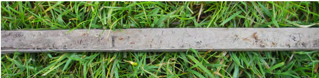
Figuur 7. Vaarroute, Ezumazijl-Oostmahorn. Foto van boring 3 met links de zodelaag en rechts het direct daaronder gelegen, door zandlaagjes onderbroken kleipakket.
