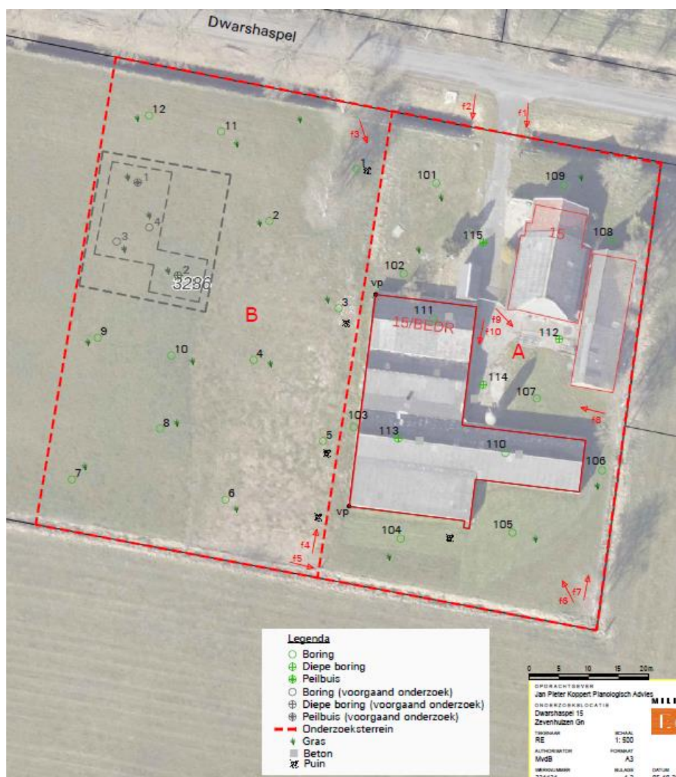
Overzicht boorlocaties (deel A: agrarisch erf; deel B: weiland nieuw te bouwen woning)
