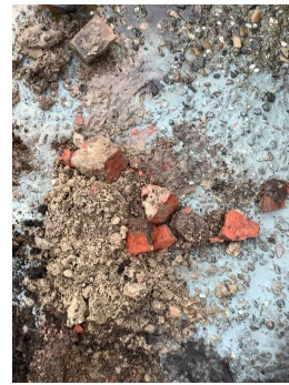
meetpunt 114, laag 10-30, bijz. metselpuin 517431745
