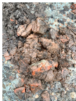
meetpunt 115, laag 10-30, bijz. metselpuin 517431747
