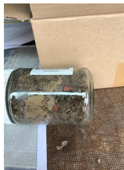
meetpunt 111, laag 4-54, bijz. metselpuin 517431744
