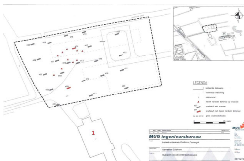
figuur 9: nader onderzoek asbest Rijksstraatweg 1
