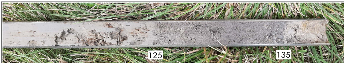
Figuur 17: Zuidhorn, Tussen de Gasten: monster boring 17 van circa 110 tot 140 centimeter diepte. Links in de guts zware zeeklei, helemaal rechts verweerd keileem en er tussenin van 125 tot 135 centimeter een oude bouwvoor van voor de overstromingen van de Lauwerszee.
