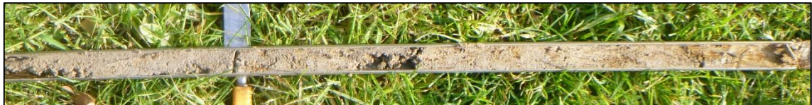
Figuur 12: Zuidhorn, Rijksweg naast 13: Foto van boring 1 met links van het mes de geroerde, humeuze toplaag en rechts van het mes, sterk lemig keizand met oxidatievlekken.
