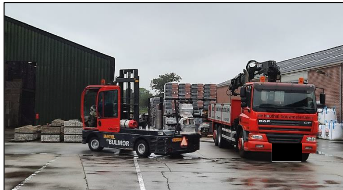
Afb. 6: laden/lossen met zijlader
