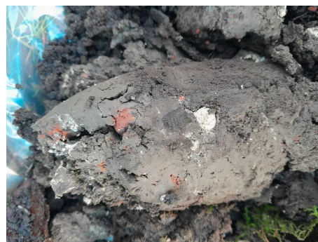
meetpunt 01, laag 0-50, bijz. metselpuin 567864175
