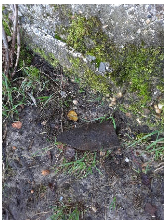
Foto 5.3: asbestverdacht materiaal op maaiveld noordelijke loods
