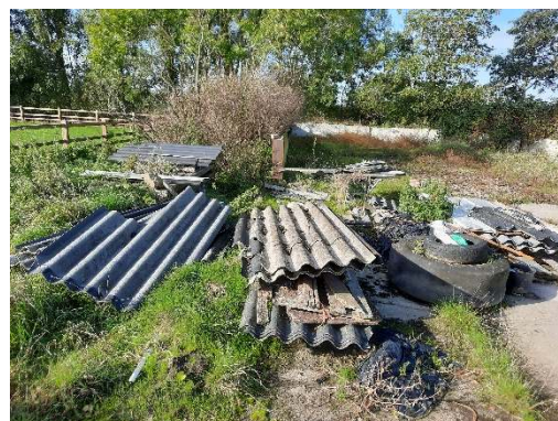
Foto 5.4: opslag asbestverdachte materialen
