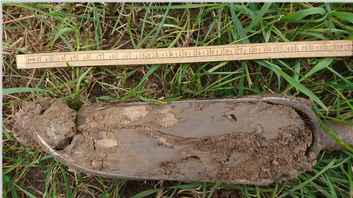
Figuur 14: Marum, Malijksepad: Boring 203, 85-95 centimeter onder maaiveld. In de boorkop zijn afwisselend klei- en zandbrokken zichtbaar.
