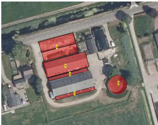
Overzicht van de te slopen bebouwing in deelgebied Jonkersvaart 19. De te slopen bebouwing en te verwijderen verharding wordt met de rode kleur aangeduid.
