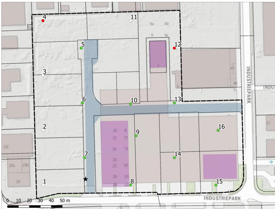
Figuur 6: Leek, Industripark: boorpuntenkaart. Het plangebied wordt begrensd door de onderbroken zwarte lijn. De zestien punten zijn boorlocaties waarvan bij rode een restant van een bodem is aangetroffen, bij groene is gegraven tot in het keileem en bij witte de boring is gestuit op verharding. Het blauwe raster geeft de weg in aanleg weer en het paarse raster nieuwe loodsen waarvan de zuidoostelijke nog in aanbouw was (zie Figuur 2). Bij de zwarte ster is een ontsluiting gefotografeerd (zie Figuur 7).
