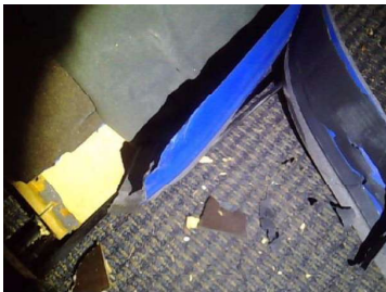
Foto 17. Binnenzijde niet-asbesthoudende strijktafel
