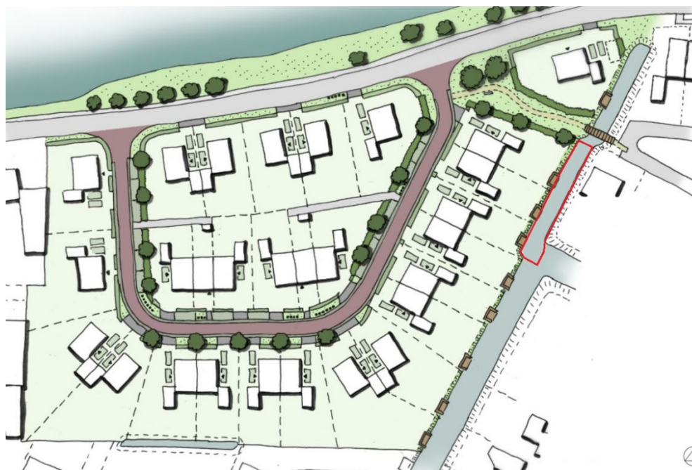
Locatie verbreden secundaire watergang (rood omlijnd)
