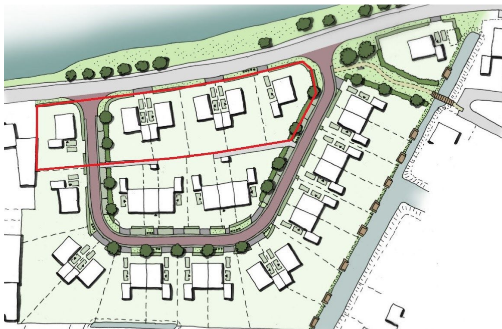
Woningen met een te hoge geluidsbelasting t.g.v. wegverkeerslawaai afkomstig van de Trekweg naar Onderdendam (betreffende woningen rood omljnd)
