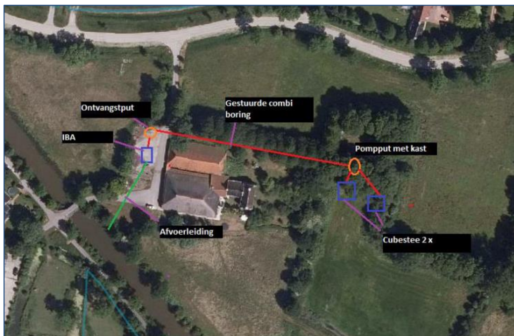
Fig. 4.9: Weergave van de oplossing om het huishoudelijke afvalwater op een verantwoorde wijze te reinigen en te lozen
