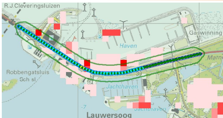
Figuur 6: Overzicht invoer RBMII en inzicht in plaatsgebonden risico 10^{-8} in het groen
