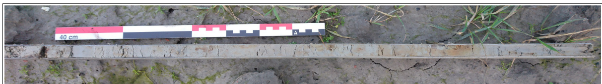
Figuur 9: Warffum, Kloosterweg: Boring 8, onderkant boor (rechts) is 150 centimeter onder maaiveld. In de boor zijn getijdenafzettingen te zien bestaande uit zand met kleilagen, roestvlekken en schelpgruis.
