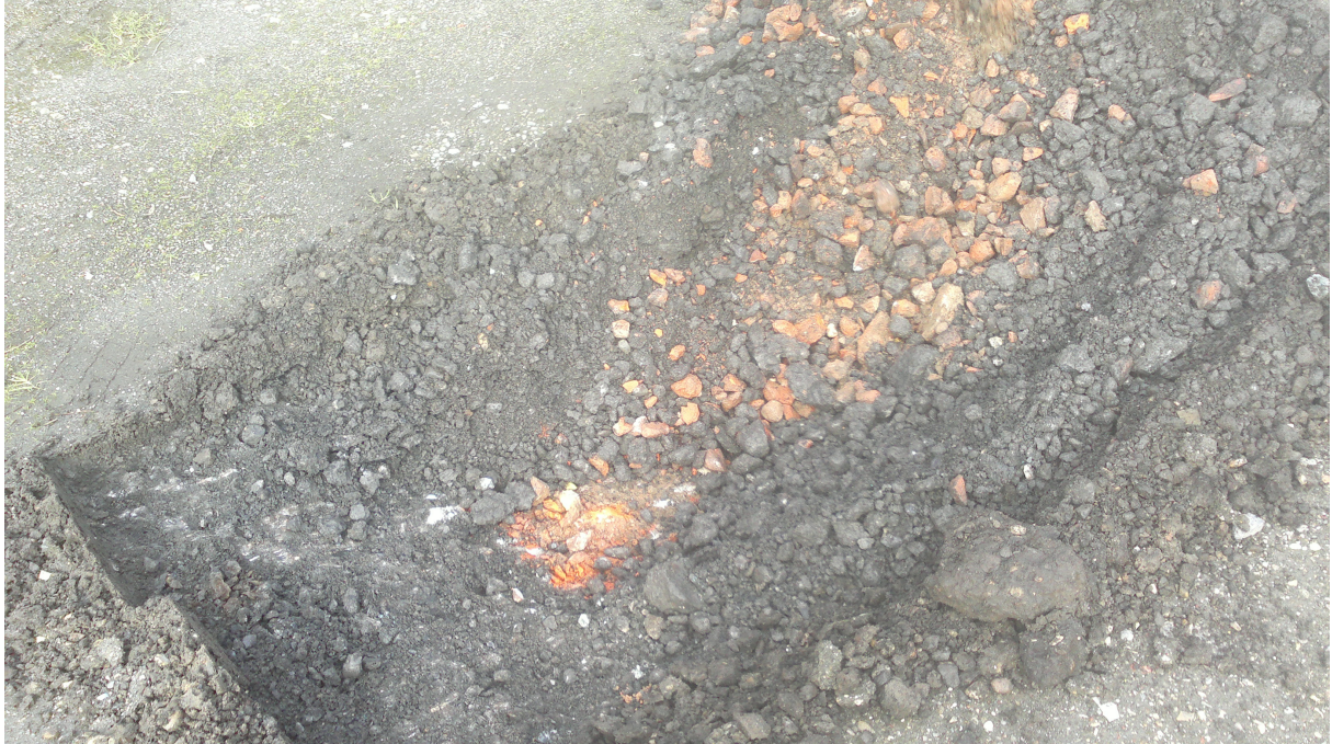
Foto 5. Slakken en puinlaag.
