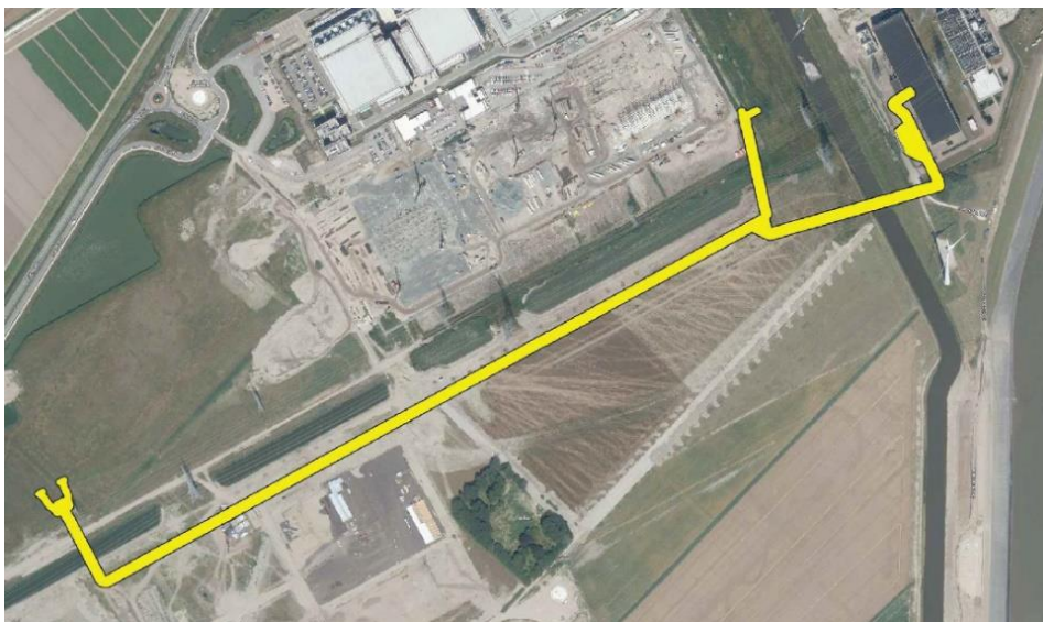
Figuur 3: Plangebied van de kabelverbinding in het geel weergegeven. De kabel wordt aangesloten op het bestaande hoogspanningsstation Robbenplaat. De kabel sluit op twee punten aan op het datacenter.
