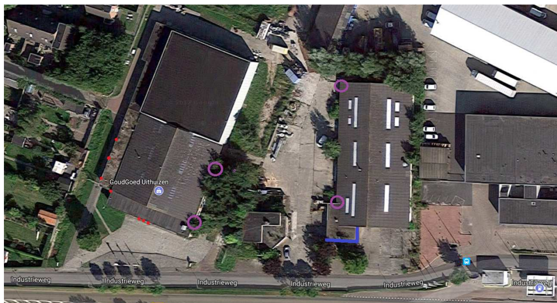
Figuur 5.1 Potentiële invliegopeningen Rode stip: Kleine invliegopening in spouw; Paarse cirkel: Toegang in spouw door grotere schade; Blauwe arcering: Invliegopeningen bij windveer.
