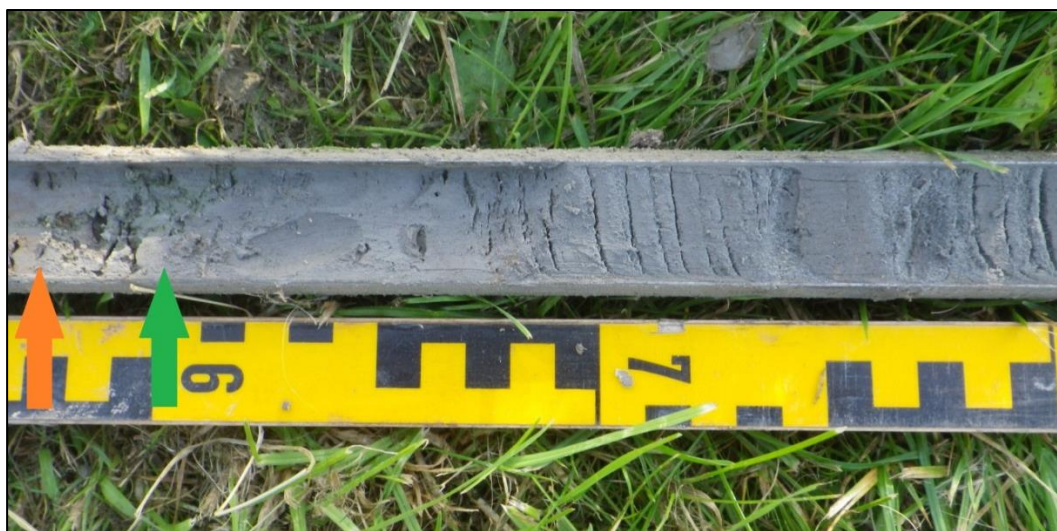
Afbeelding 6. Boring 5, detail van de boring. Bij de oranje en groene pijl respectievelijk lichte oranje- en groenkleuring door neerslag van ijzer- en fosfaatmineralen. Verder naar onder zijn sterk gelaagde kwelderafzettingen zichtbaar (ter hoogte van 68 en 80 cm op de mee gefotografeerde meetlat).
