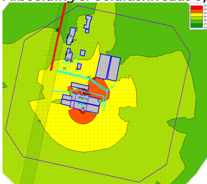
Afbeelding 5: Geluidsniveaus op contour op 50 meter van grens inrichting
