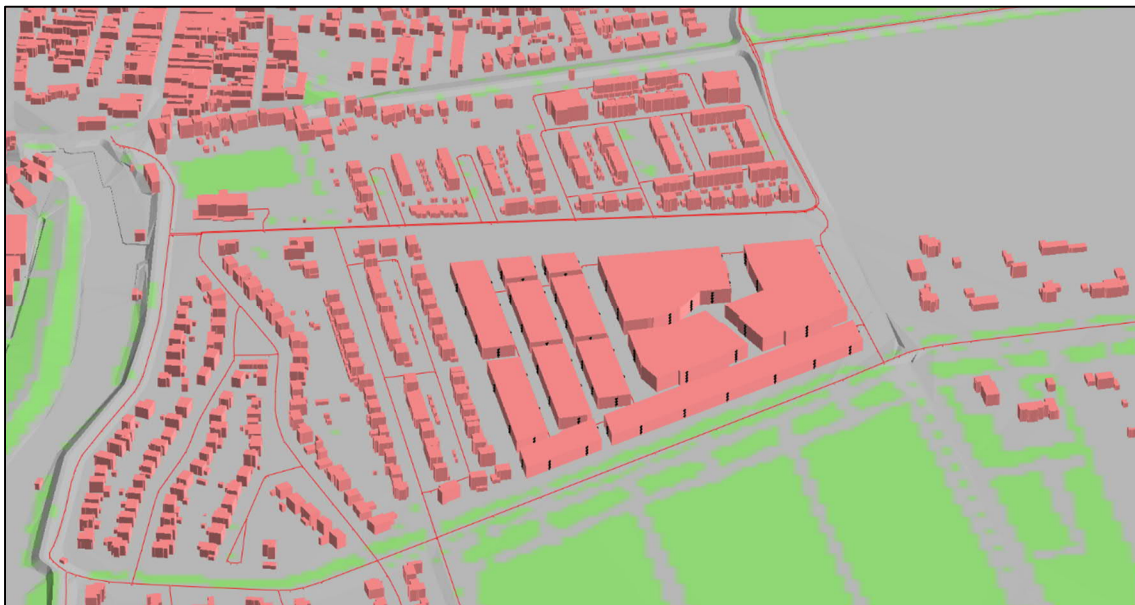
Afbeelding 4 3D-weergave geluidsmodel ten behoeve van berekening functievlakken (plangrenzen) fase D
