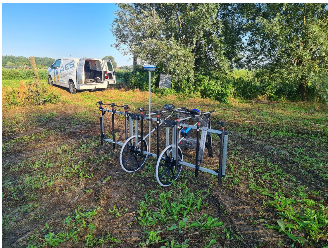
Figuur 3-2: Afbeelding met daarop weergegeven het multisonde systeem gemonteerd aan een STL-H8
