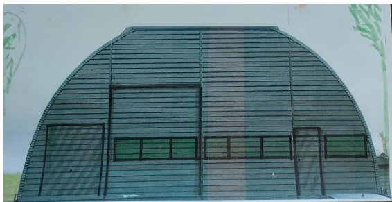
Figuur 3.4 tekening aangepaste voorgevel romneyloods
