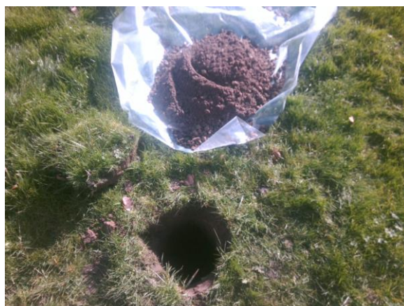
Foto 2. Asbestinspectiegat, opgegraven en gezeefd materiaal D02
