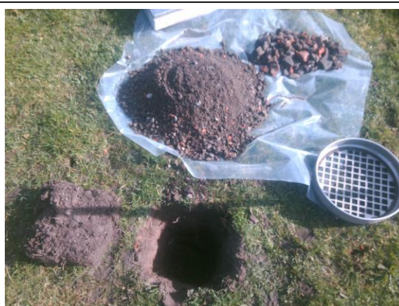
Foto 4. Asbestinspectiegat, opgegraven en gezeefd materiaal D04
