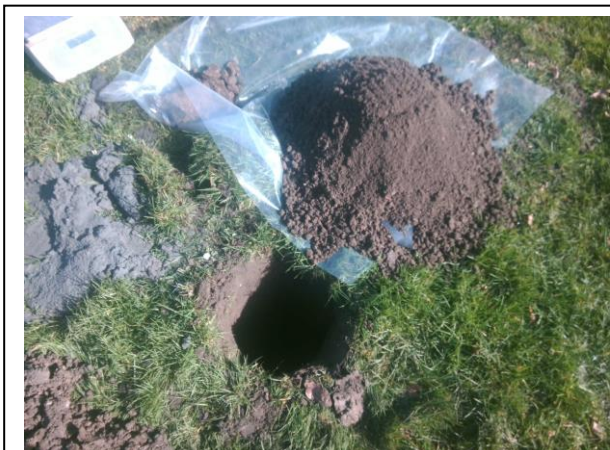
Foto 1. Asbestinspectiegat, opgegraven en gezeefd materiaal D01
