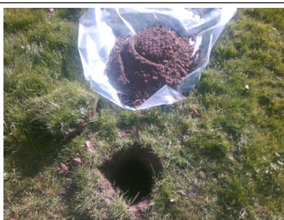
Foto 2. Asbestinspectiegat, opgegraven en gezeefd materiaal D02
