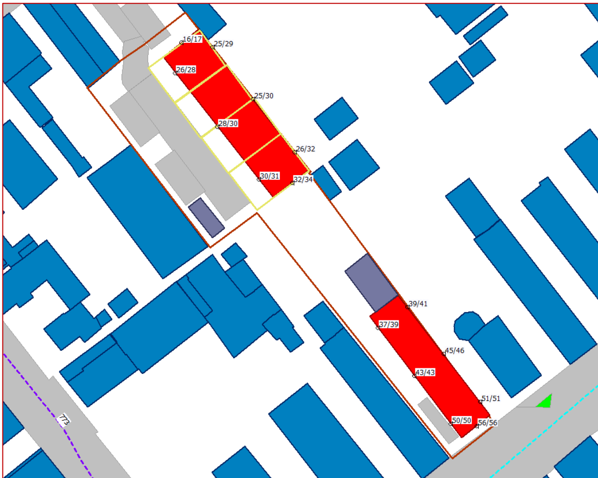
Figuur 4.3: Rekenresultaten vanwege de Rijkestraat met 5 dB aftrek.
