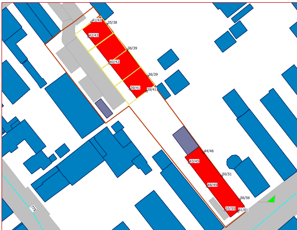
Figuur 4.5: Gecumuleerde rekenresultaten wegverkeerslawaai, zonder aftrek.
