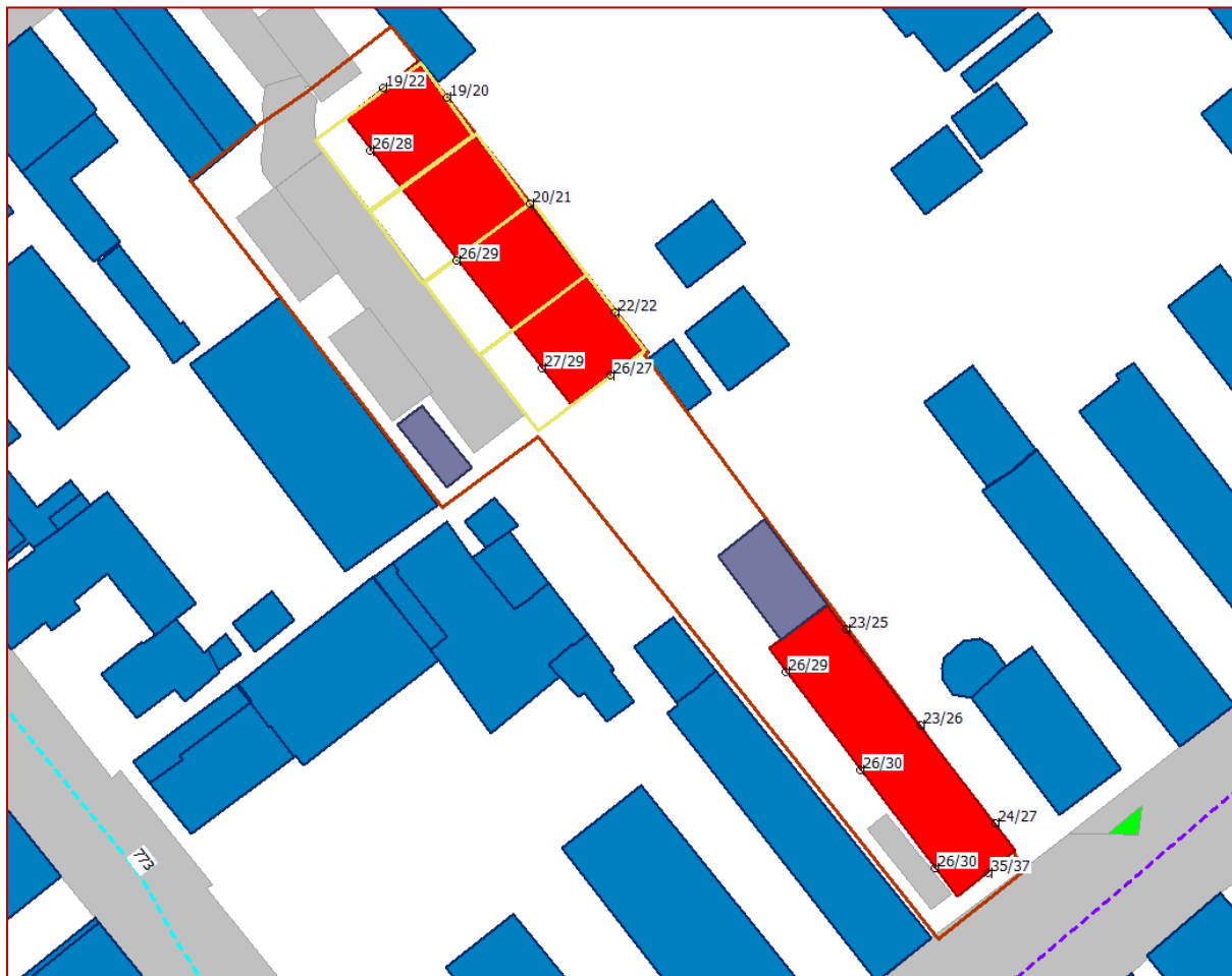
Figuur 4.2: Rekenresultaten vanwege de Langestraat met 5 dB aftrek.
