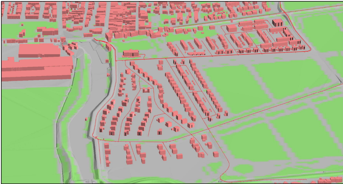
Afbeelding 11 3D-weergave computersimulatiemodel ten behoeve van berekening verkavelingen fase 1a, 1b en 1c
