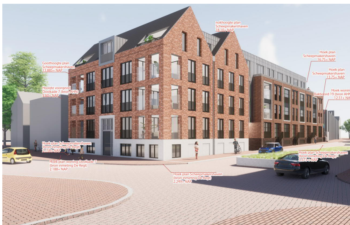
Afbeelding 2.8. Bouwhoogten ten opzichte van het Normaal Amsterdams Peil (NAP). Op het zuidwestpunt (Scheepmakershaven) ligt het aansluitend terrein op 2,158 +NAP, op het noordoostpunt (Ankerplaats) op 3,373 +NAP.
