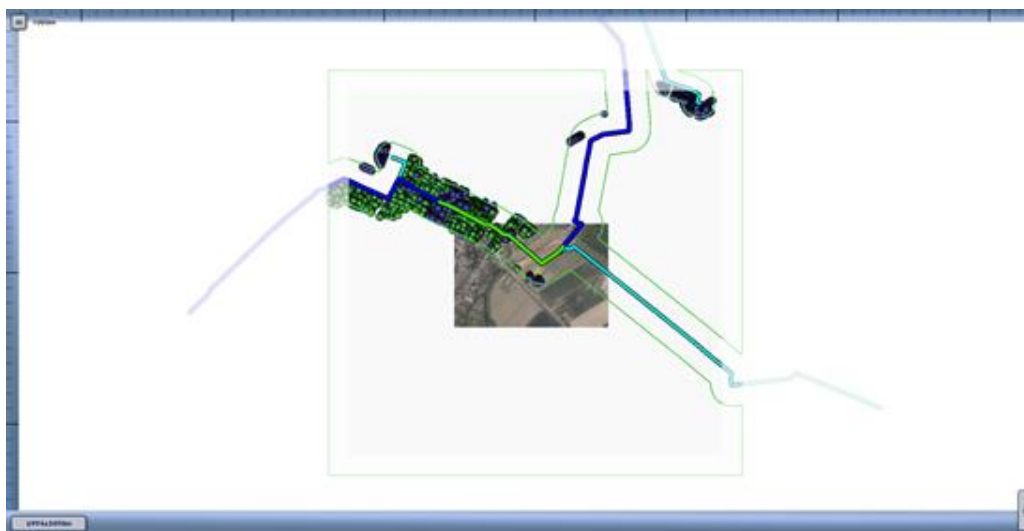
Figuur 8: Kilometer leiding behorende bij de maximale overschrijding van de FN-curve voor 8465_leiding-W-507-01-deel-1 van N.V. Nederlandse Gasunie voor de huidige situatie (groen gearceerd).
