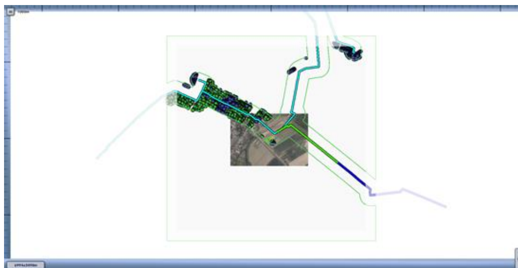
Figuur 14: Kilometer leiding behorende bij de maximale overschrijding van de FN-curve voor 8465_leiding-W-524-01-deel-1 van N.V. Nederlandse Gasunie voor de nieuwe situatie (groen gearceerd).
