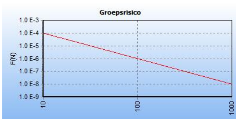
Figuur 18: FN curve voor 8465_leiding-W-524-01-deel-1 van N.V. Nederlandse Gasunie voor de kilometer tussen stationing 0.00 en stationing 1000.00.
