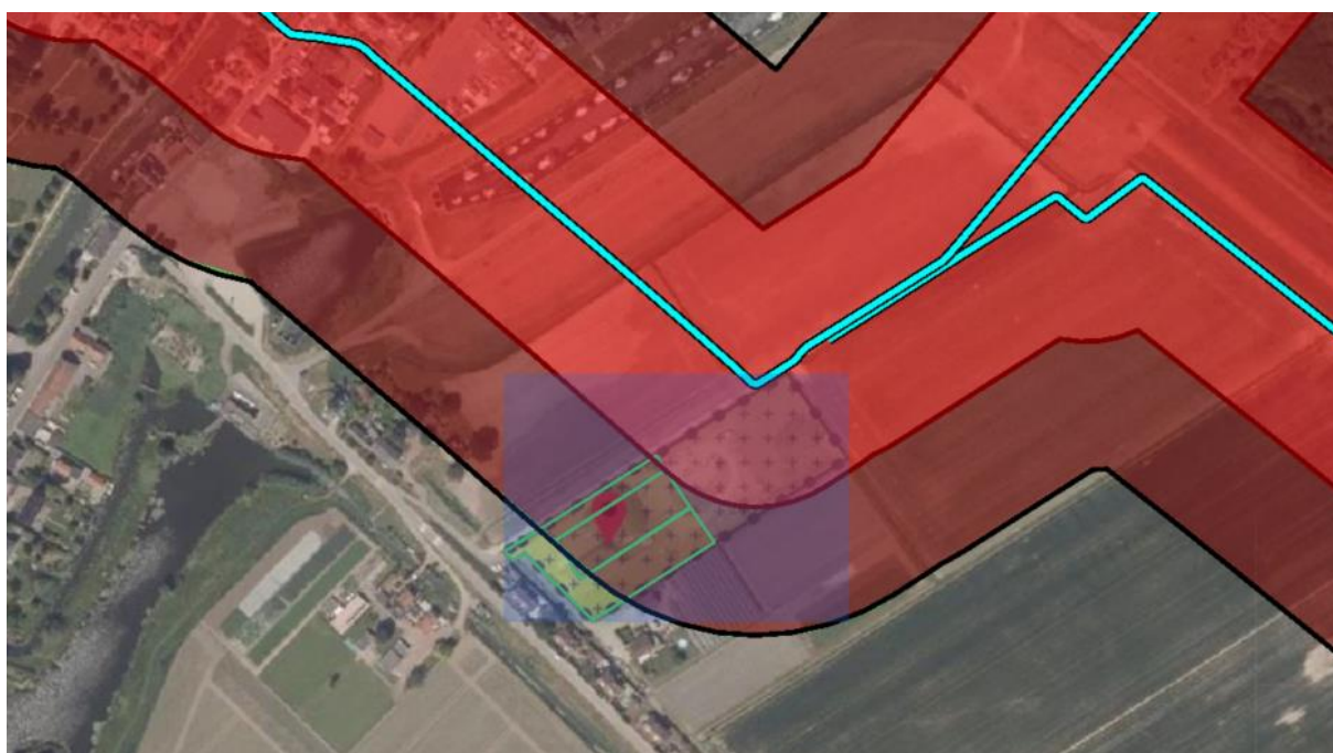
Figuur 5: Invloedsgebied van 8465_leiding-W-507-01-deel-1 en 8465_leiding-W-524-01-deel-1 van N.V. Nederlandse Gasunie. Lichtrood: 100% letaliteitscontour, donkerrood: 1% letaliteitscontour.
