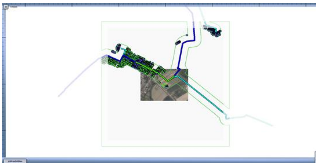
Figuur 12: Kilometer leiding behorende bij de maximale overschrijding van de FN-curve voor 8465_leiding-W-507-01-deel-1 van N.V. Nederlandse Gasunie voor de nieuwe situatie (groen gearceerd).
