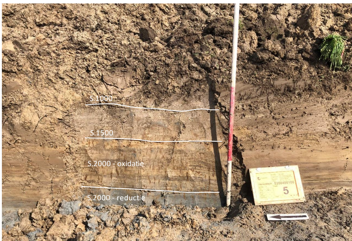
Figuur 6. Profiel 3.3 in de oostelijke wand van werkput 3. De oxidatie- en reductiehorizont van de overstromingsafzettingen zijn hier duidelijk zichtbaar.
