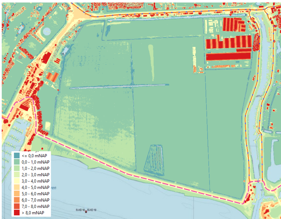
Figuur 2 Maaiveldhoogte bestaande Molenpolder (bron: AHN.nl)
