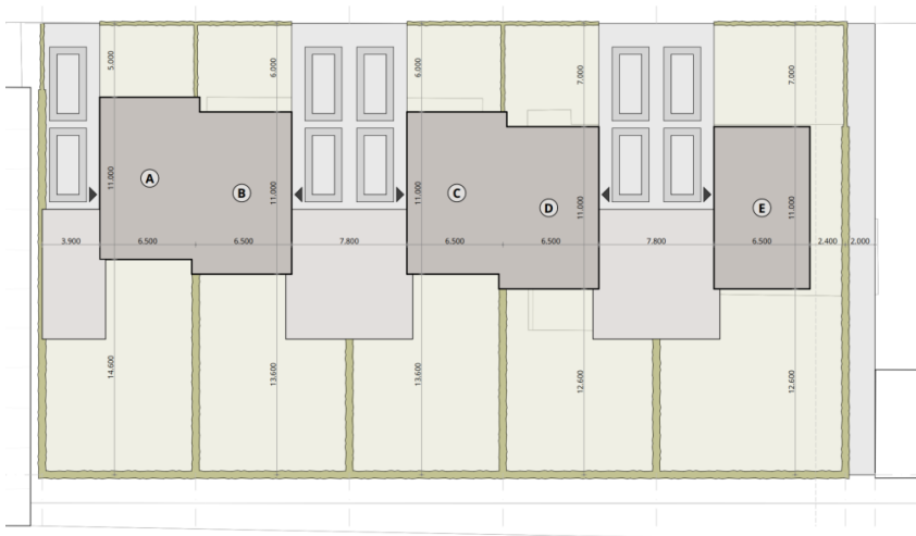
Figuur 4.4 parkeerplaatsen bij woningen
