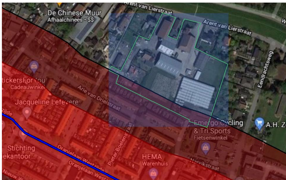
Figuur 5: Invloedsgebied van 7363_leiding-W-507-05-deel-1 van N.V. Nederlandse Gasunie. Lichtrood: 100% letaliteit, donkerrood: 1% letaliteit.
