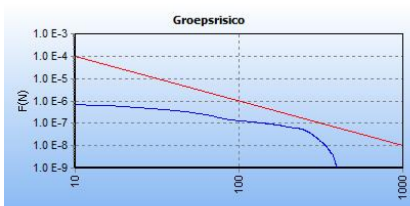
Figuur 12: FN curve voor 7363_leiding-W-507-01-deel-1 van N.V. Nederlandse Gasunie voor de kilometer tussen stationing 3460.00 en stationing 4460.00
