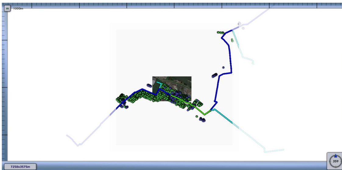
Figuur 8: Kilometer leiding behorende bij de maximale overschrijding van de FN-curve voor 7363_leiding-W-507-01-deel-1 van N.V. Nederlandse Gasunie voor de huidige situatie (groen gearceerd).
