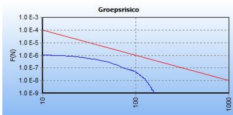
Figuur 4: FN curve huidige situatie voor 6339_leiding-W-507-01-deel-1 van N.V. Nederlandse Gasunie voor de kilometer tussen stationing 3680.00 en stationing 4680.00 (Bron: 1901b Rapportage QRA hogedruk aardgastransportleiding Boezemkade 9, Puttershoek, figuur 9)
