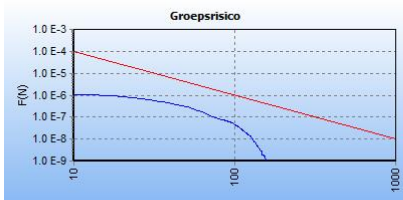
Figuur 5: FN curve beoogde situatie voor 6339_leiding-W-507-01-deel-1 van N.V. Nederlandse Gasunie voor de kilometer tussen stationing 3680.00 en stationing 4680.00 (Bron: 1901b Rapportage QRA hogedruk aardgastransportleiding Boezemkade 9, Puttershoek, figuur 10)
