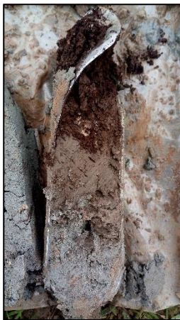
Boring 8: Detailopname 125-145cm -Mv. Hier is zowel de top van het veen, Duinkerke I en Duinkerke III zichtbaar.
