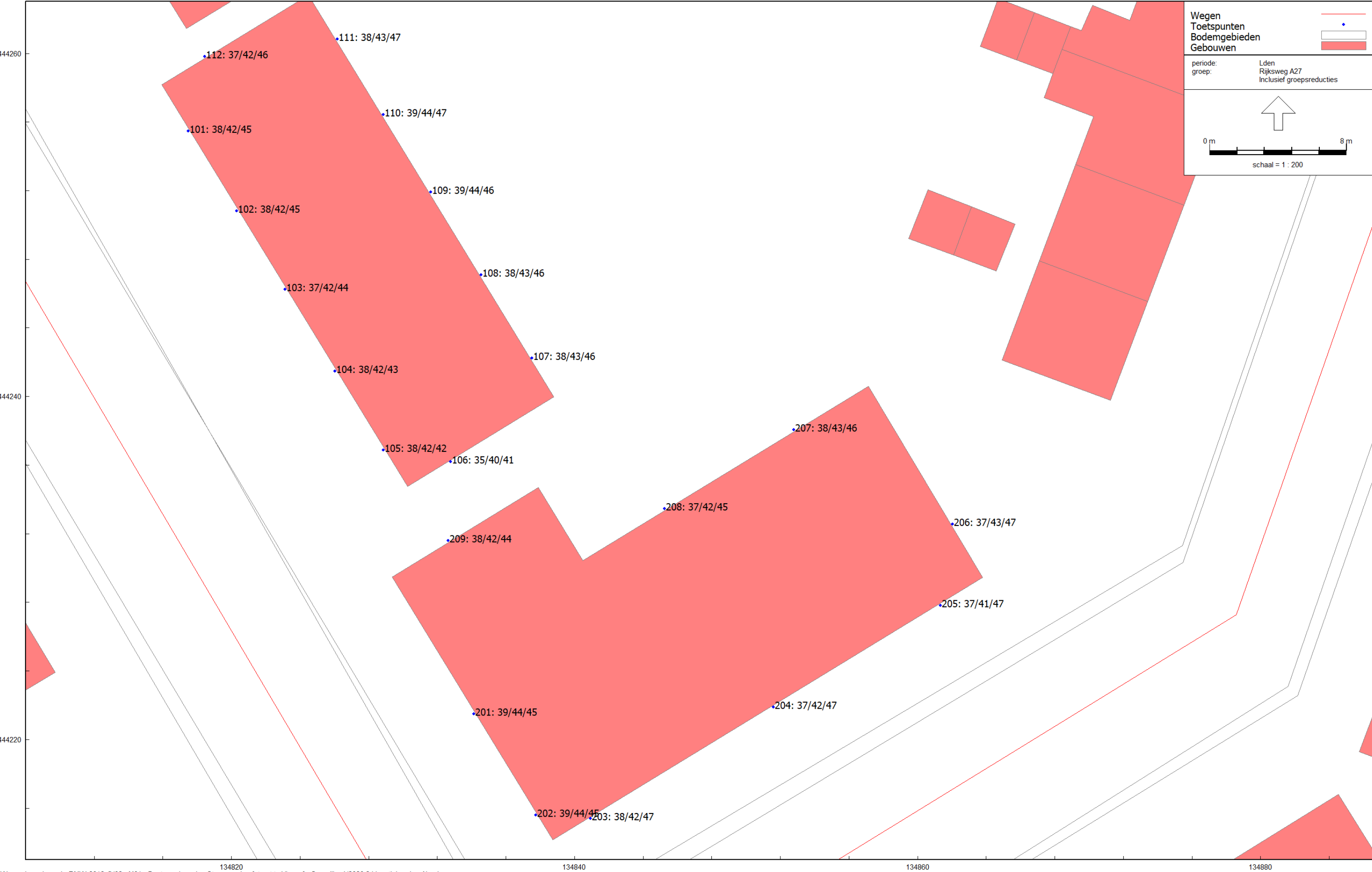
Figuur 6 Geluidsbelastingen vanwege wegverkeer op de Rijksweg A27 inclusief 2 dB cor. ex. art.110g Wgh Beoordelingshoogte 1,5 / 4,5 en 7,5 meter
