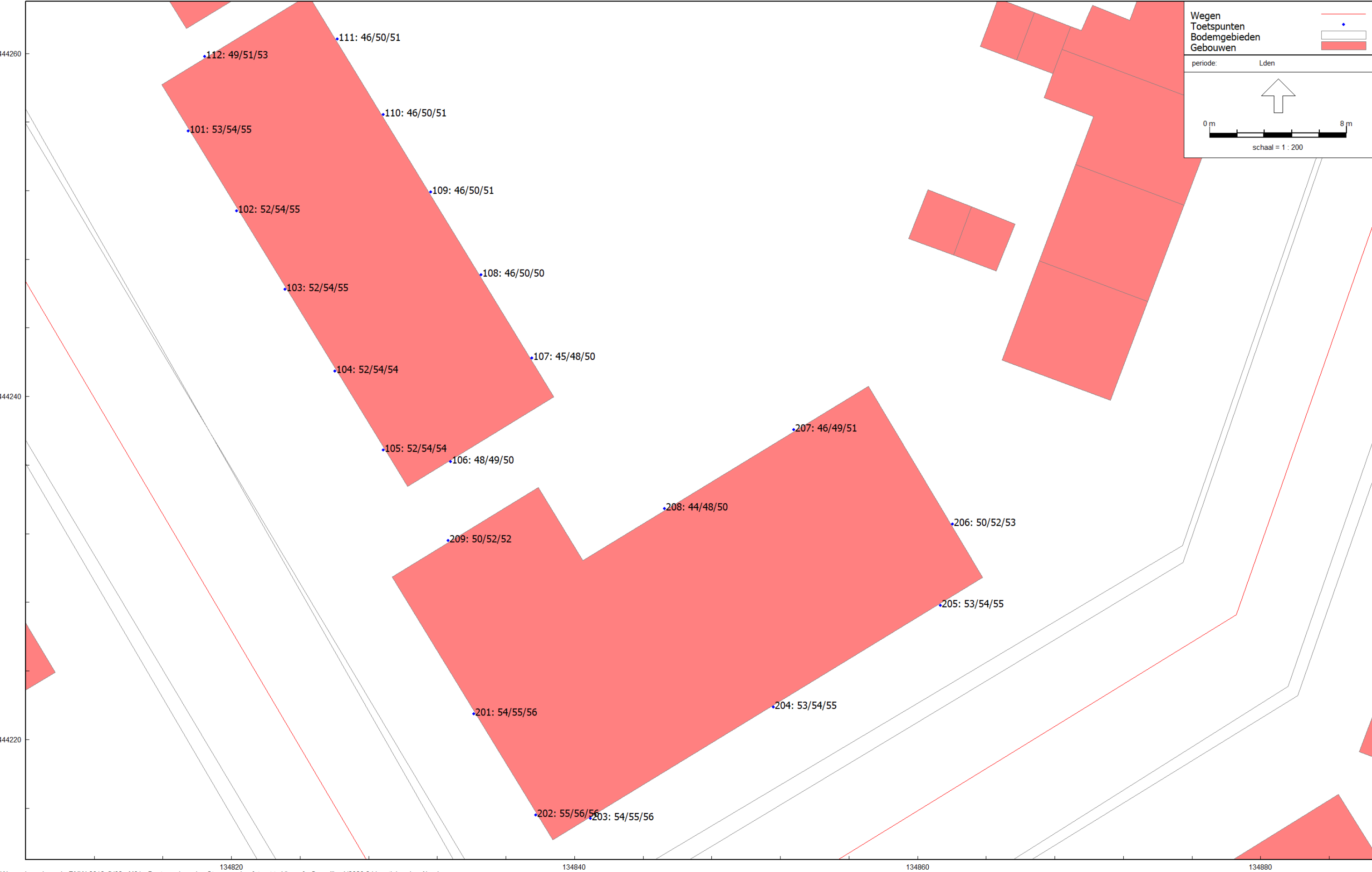
Figuur 7 Gecumuleerde geluidsbelastingen vanwege wegverkeer op de omliggende wegen exclusief 2 en 5 dB cor. ex. art.110g Wgh Beoordelingshoogte 1,5 / 4,5 en 7,5 meter
