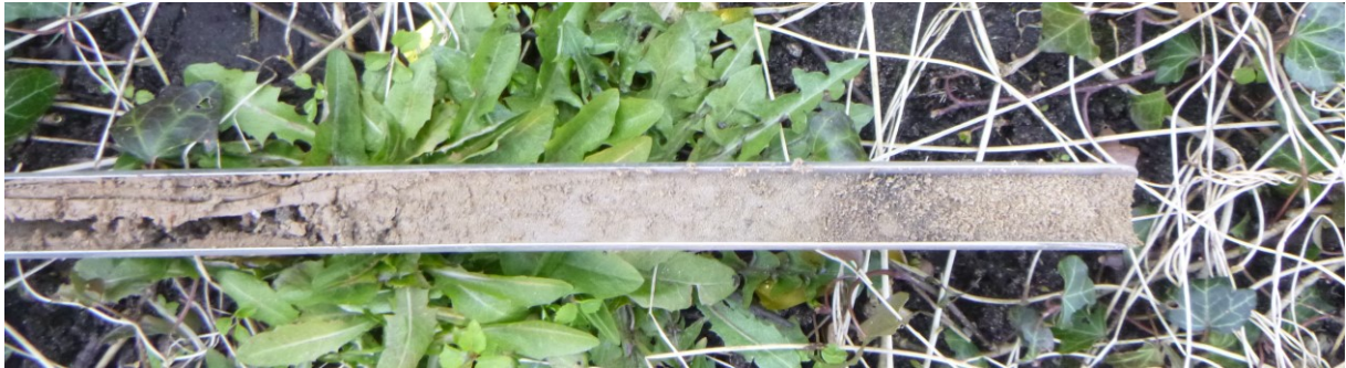
Figuur 21: Foto van het grove zand (rechts) dat op alle boorpunten onder de matig zandige klei is aangetroffen.
