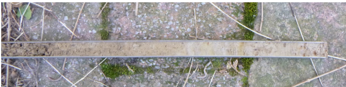
Figuur 20: Foto van de matig stevige klei met zandlaagjes (rechts) met daar boven op het pakket vergraven klei (links).
