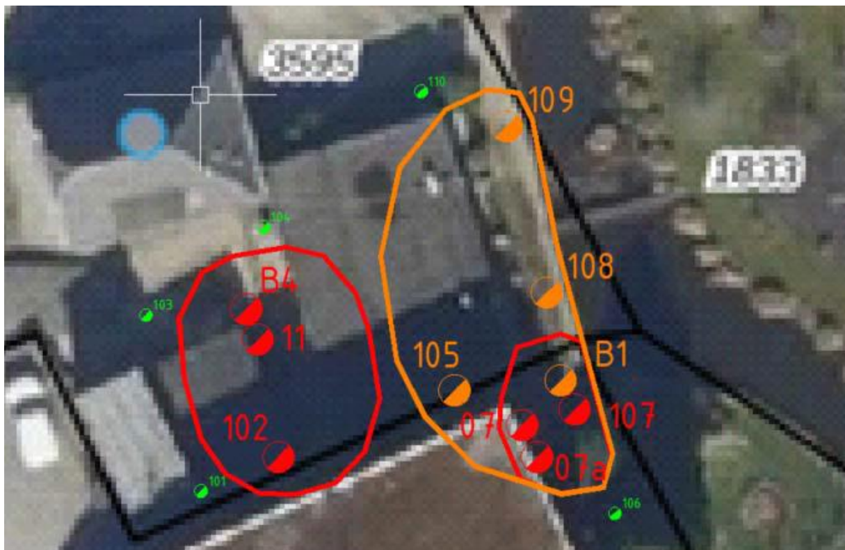
Afbeelding 14: Situatie met de boringen van de matige lood- en zinkverontreiniging (oranje) en twee sterke minerale olieverontreinigingen (rood)
