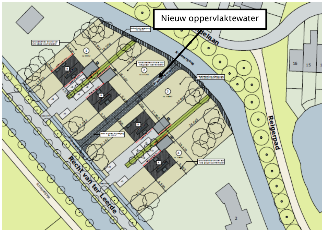
Afbeelding 11: Nieuw te graven oppervlaktewater (uitvergroet in bijlage)
